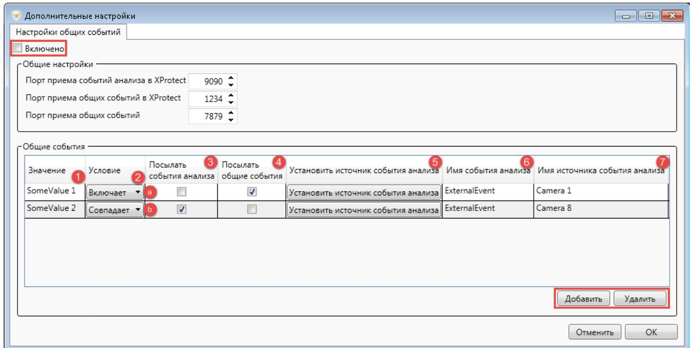
Рис. 12: Прием общих событий из сторонних источников в составе функциональности модуля **Analytic Server**
